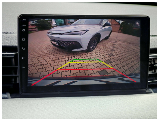
Kamera cofania z dynamicznymi liniami pomocniczymi
